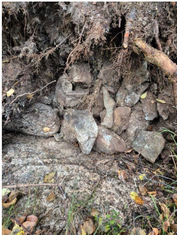
Figur 7 Sten och block i markytan. Svårt att provta med skruvprovtagare.
