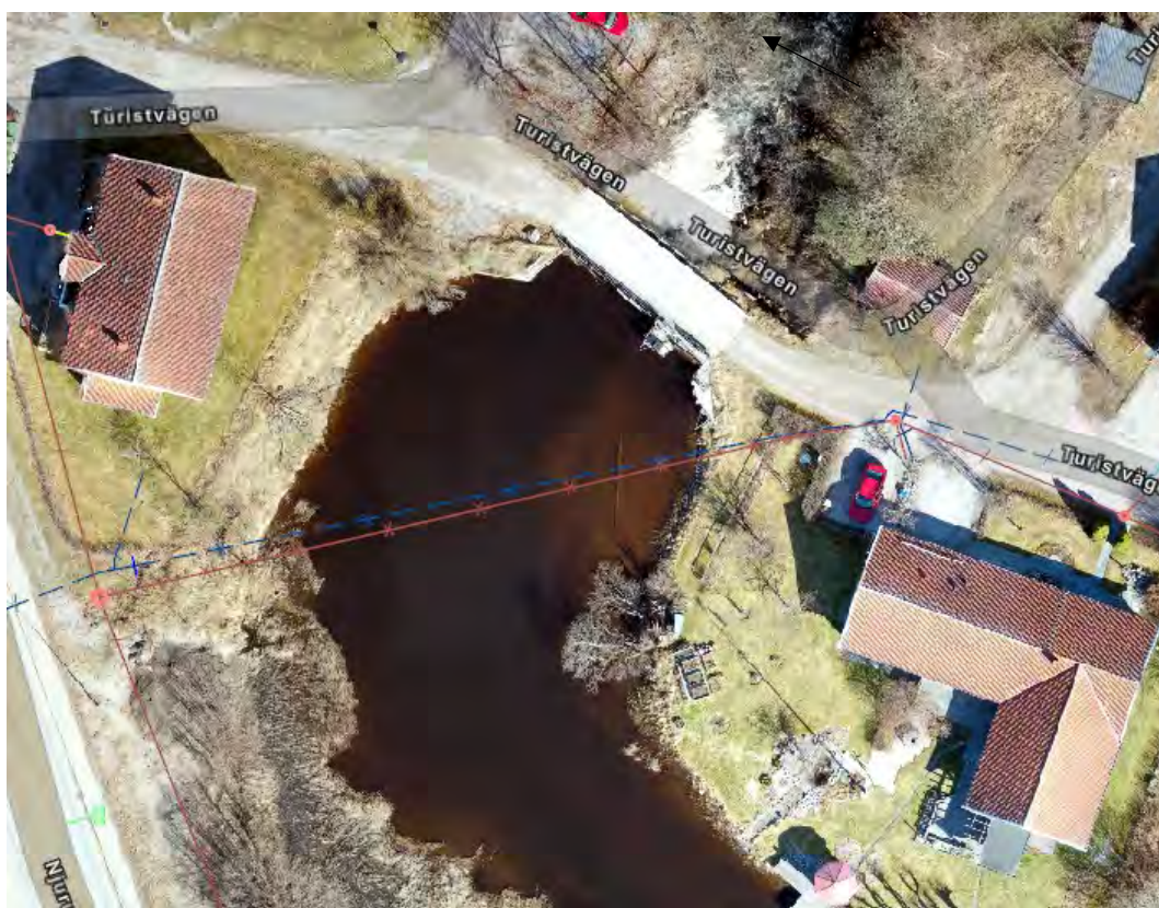
Figur 11. Kartutdrag av befintliga VA-ledningar strax uppströms damm 4.
